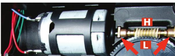
Achten Sie beim Austausch des Motors und der Getriebewelle auf die richtige Position der Führungskufen (L). Fetten Sie die Welle gründlich und gleichmäßig ein.
