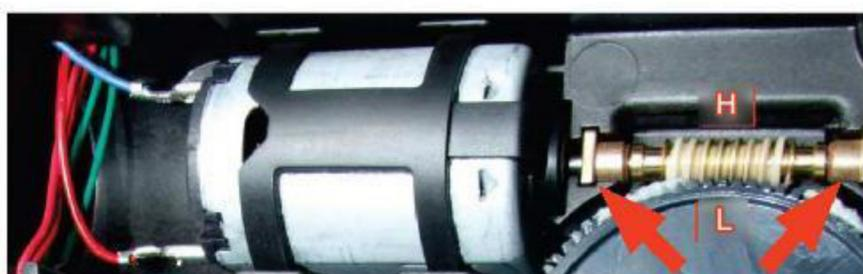
Achten Sie beim Austausch des Motors und der Getriebewelle auf die richtige Position der Führungskufen (L).
